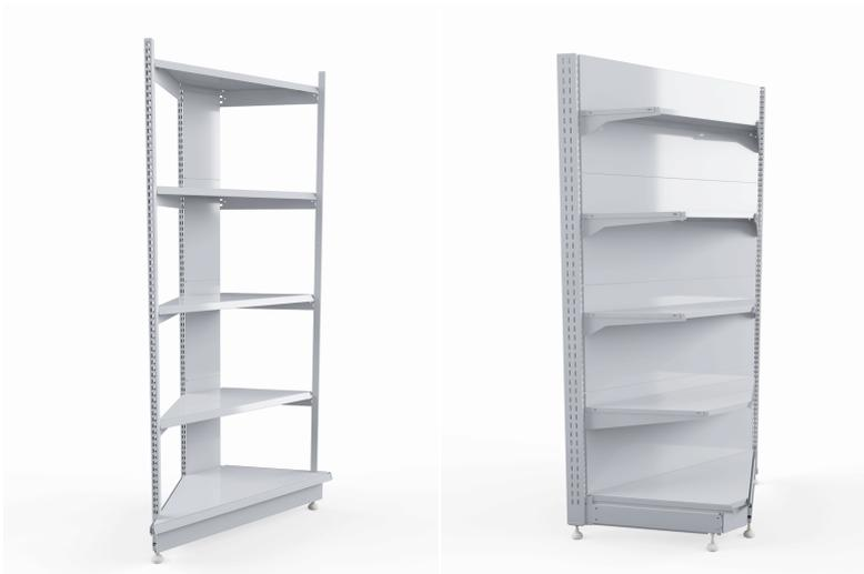
Угловая секция пристенного стеллажа. Угол внутренний. Полки прямые, цельные, металлические. Задние панели сплошные, металлические. Предназначен для перехода линейного стеллажа под угол 90 градусов.
